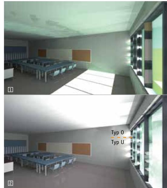
Die Simulation zeigt: Im Vergleich zu herkömmlichen Isoliergläsern (Bild 1) können die Tageslichtverhältnisse durch den Einsatz von OKASOLAR F O und OKASOLAR F U (Bild 2) optimiert werden.
