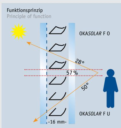
Dank des extrem schmalen Profilquerschnitts ist die horizontale Durchsicht auf 57 % verbessert worden.
