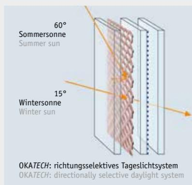
Die asymmetrisch ausgestellten Metallperforationen funktionieren als richtungsselektives Tageslichtsystem und sorgen für effektiven thermischen Sonnenschutz.
